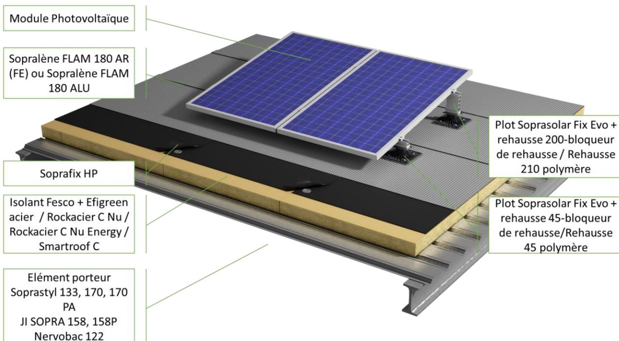
**Figure 2 : Procédé en version SOPRASOLAR FIX EVO TILT - TAN GP sur élément porteur TAN GP avec revêtement d'étanchéité bicouche fixé mécaniquement et modules photovoltaïques**
