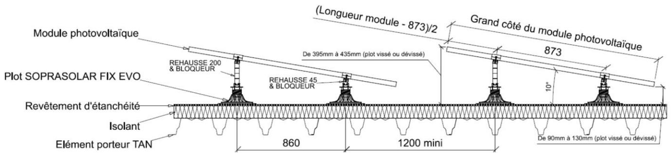
**Figure 7 : Vue en coupe (dans le sens de la longueur des modules) du procédé avec modules photovoltaïques de longueur 1755mm en inclinaison simple shed**
