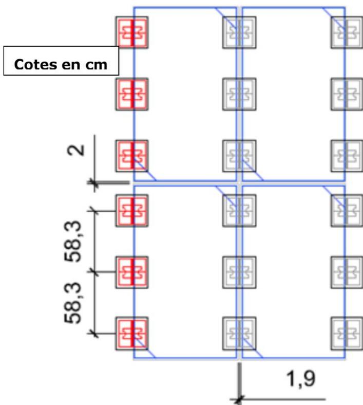
Figure 34 : Implantation des plots SOPRASOLAR FIX EVO en calepinage densifié
