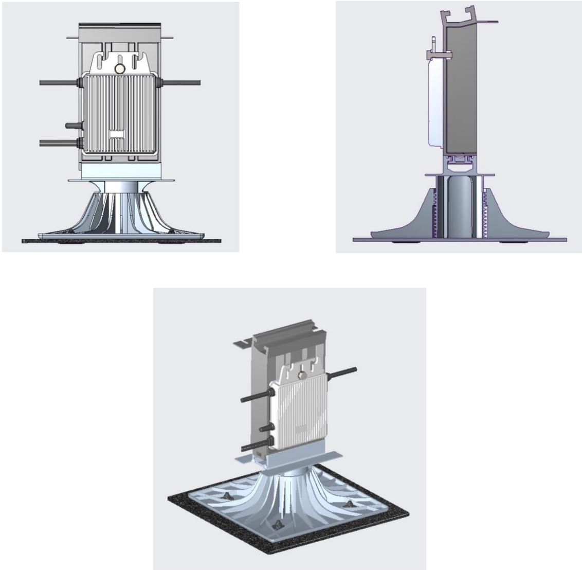
**Figure 26 : Mise en place micro onduleur sur réhausse polymère – diamètre du perçage 9mm**
