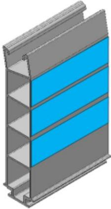
Zone autorisée pour la mise à la terre des rehausse avec vis autoforeuse
