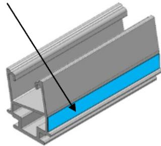
Localisation zone de perçage pour mise à la terre des rehausse Aluminium par vis autopercuse (mise à la terre de la rehausse 200 aluminium uniquement)
