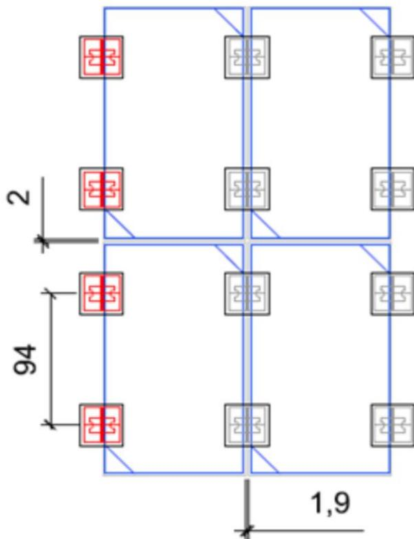
Figure 33 : Implantation des plots SOPRASOLAR FIX EVO en calepinage non densifié
