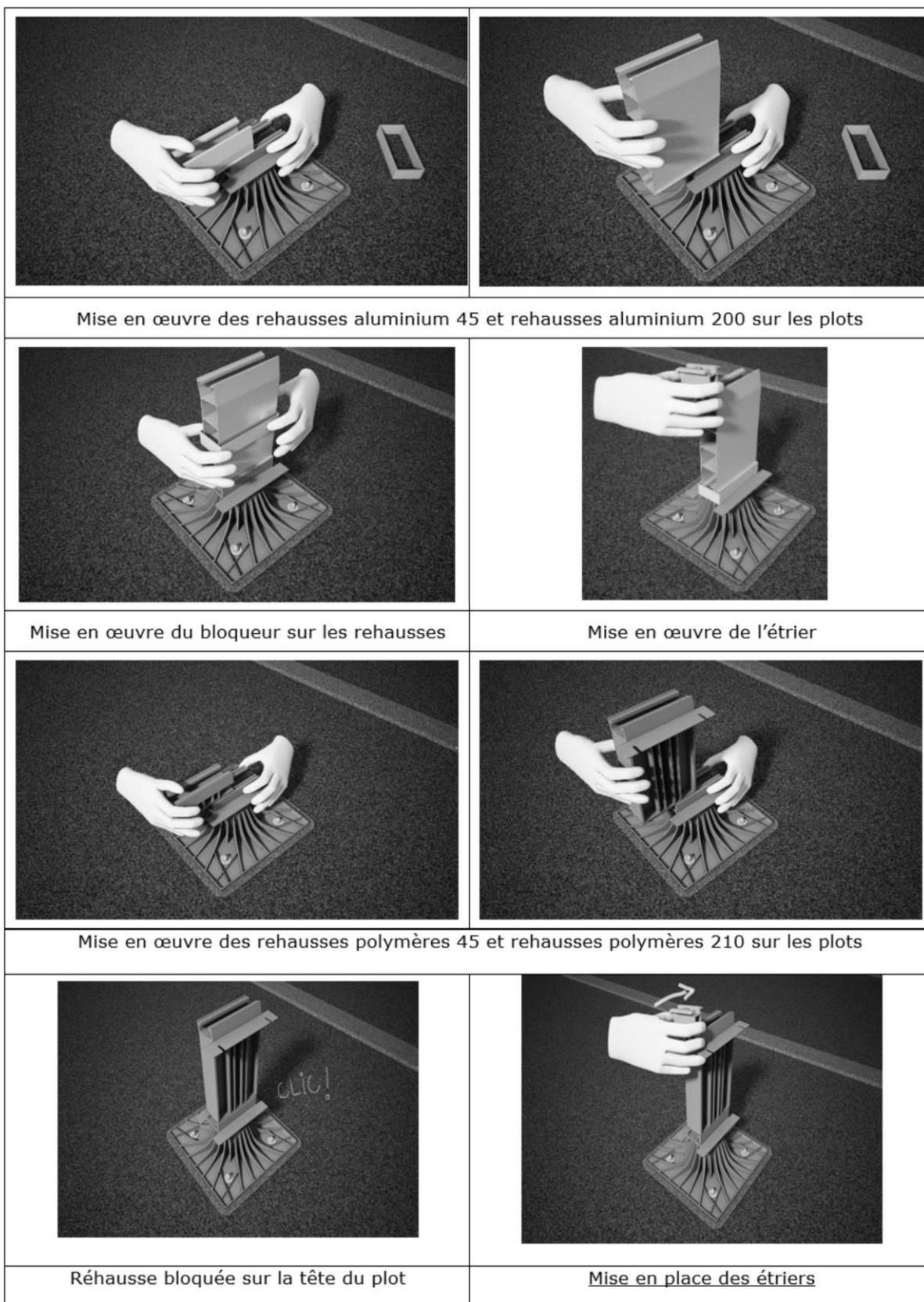
**Figure 37 : Mise en œuvre des rehausses et bloqueurs**
