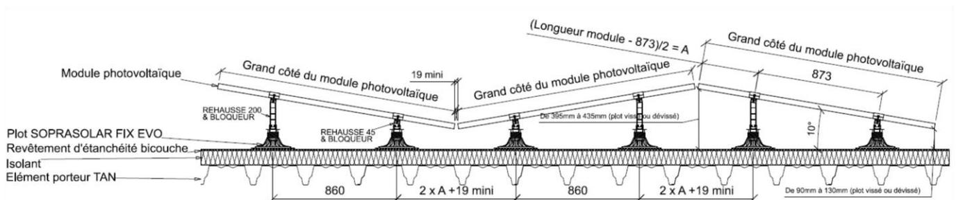
**Figure 6 : Vue en coupe (dans le sens de la longueur des modules) du procédé avec modules photovoltaïques de longueur 1755mm en inclinaison double shed**
