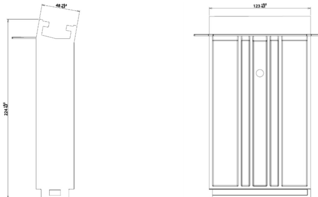
**Figure 17 : Plan Réhausse 210 polymère – diamètre du perçage 9mm**
