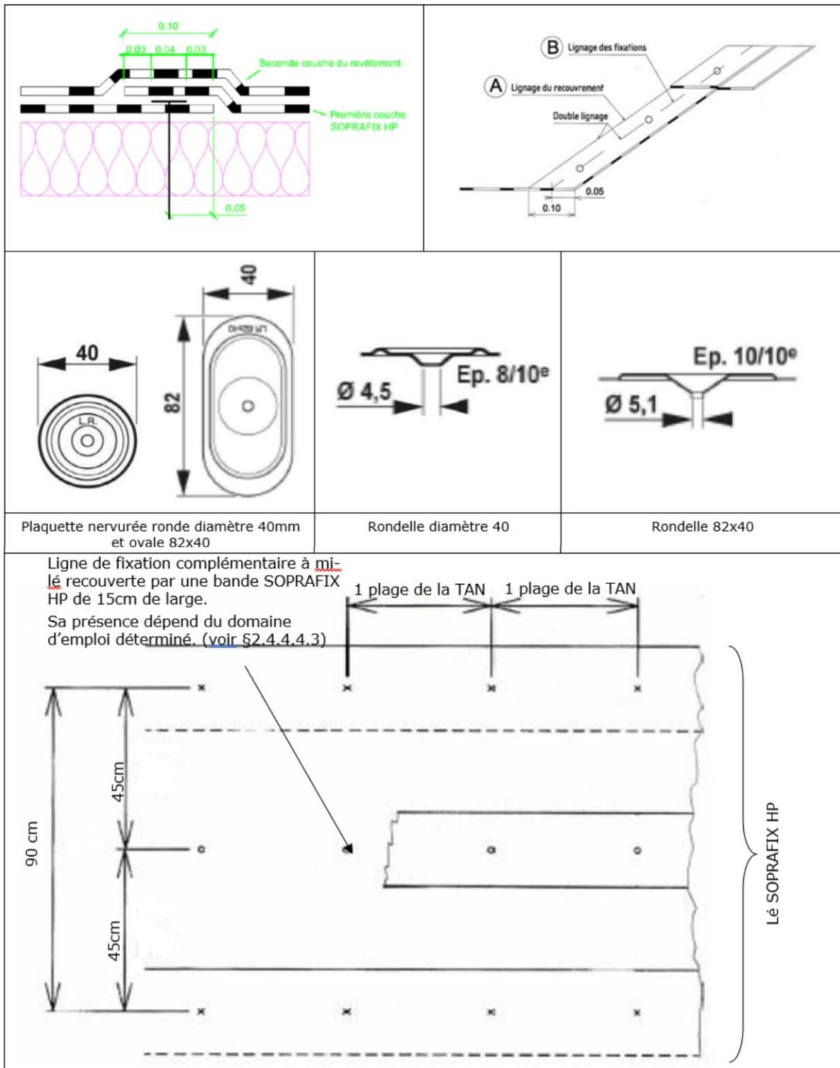
**Figure 27 : Mise en œuvre du revêtement d'étanchéité avec première couche SOPRAFIX HP et plaquette de répartition**
