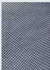
Le drain Retentio® est constitué d'une grille extrudée associée à un géotextile non tissé thermolié.
