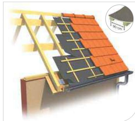
**Sopreflex XP** est posé parallèlement à la gouttière avec un recouvrement de 10 cm entre les lés et un débord de 10 cm sur la bande de rive.
