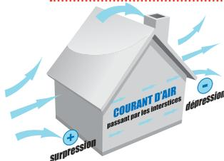
Un bâtiment subit les effets du vent de façon plus ou moins importante en fonction de son emplacement géographique. La qualité de l'enveloppe et son étanchéité au vent vont donc être essentielles pour éviter que, sous la pression du vent, l'air ne s'infilte par les défauts de la construction.
