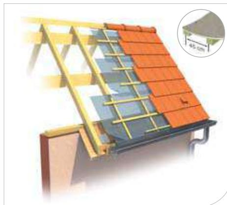
**Plastigrille** est déroulé parallèlement à l'égout avec un recouvrement de 10 cm entre les lés et un débord de 10 cm sur la bande de rive.
